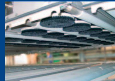
Deux à quatre ponts de polissage oscillants
